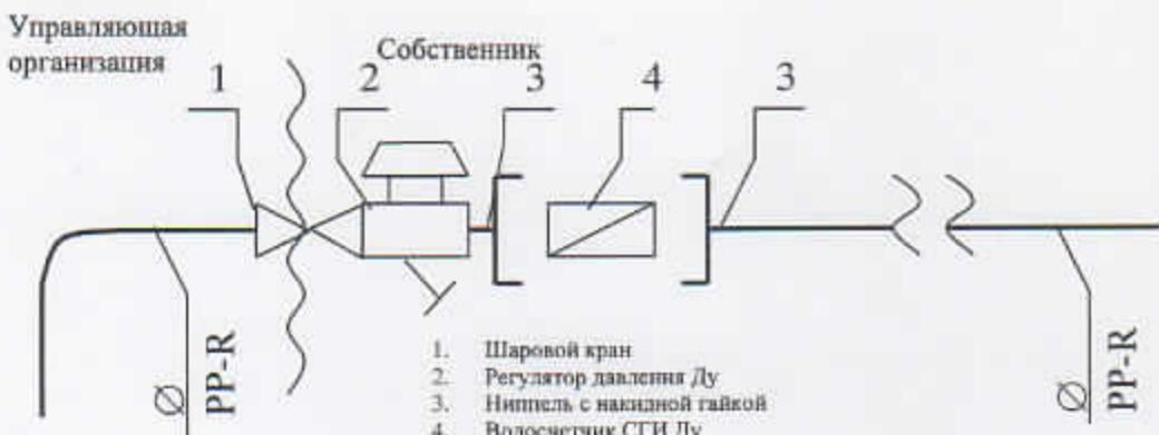
Исполнитель несет ответственность за надлежащее состояние и работоспособность систем горячего и холодного водоснабжения согласно вышеуказанной схеме до волнистой линии слева (исключая шаровой кран).
